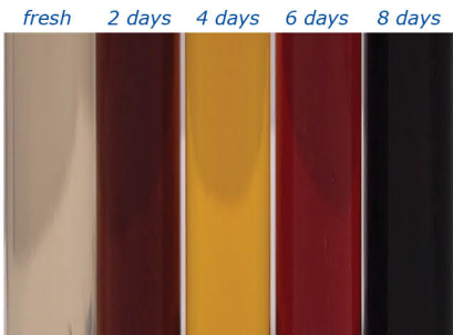
Deutliche Farbvariationen eines künstlich gealterten Öls, bei dem die beiden Phasen der Farbveränderung auf Additivverbrauch gefolgt von Basisölalterung hinweisen
