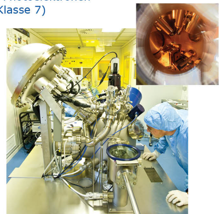
Small-Spot Röntgen-Photoelektronen-Spektrometer mit Analysenkammer (rechts oben) im AC²T-Reinraum
