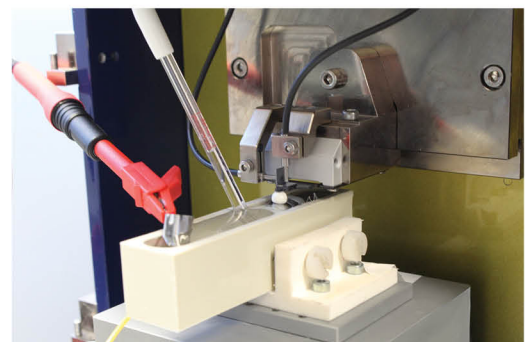
Tribokorrosionsaufbau im Mikrolasttribometer
